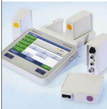
SevenExcellence può montare fino a tre moduli in qualsiasi configurazione e sequenza e si può espandere in qualsiasi momento aggiungendo nuovi parametri di misura. Le interfacce USB, Ethernet e RS232 consentono il collegamento di lettori di codici a barre e di impronte digitali, scambiatore di campioni Rondolino, chiavetta USB e stampanti METTLER TOLEDO o di rete.
