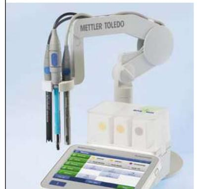
uPlace™: il braccio portaelettrodo può essere azionato con una sola mano e il movimento perfettamente verticale permette di portare l'elettrodo nella giusta posizione. In questo modo le misurazioni risultano più rapide e si riduce il rischio di rovesciare il recipiente del campione e di danneggiare il sensore.
