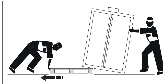
Rimosso il pallet, abbassare l'armadio lentamente e senza scossoni per evitare danneggiamenti.
