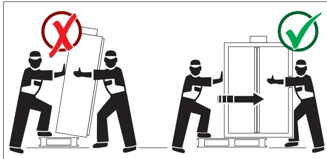
Quando l'armadio arriva ad appoggiarsi a terra, sostenerlo per permettere la rimozione del pallet.
