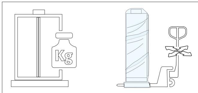
Movimentare con un transpallet l'armadio, in posizione verticale, bloccato e protetto dallo scivolamento sino al punto di installazione definitivo.
